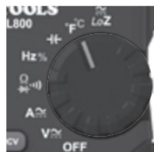
**!** *Retirez le thermocouple avant de sélectionner une autre fonction du multimètre.*
