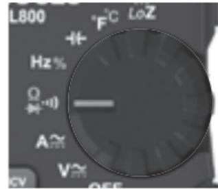
**NOTA:** Cuando el multímetro está en la posición de medir resistencia y los cables de prueba están en circuito abierto (no conectados a través de un resistor), o cuando se está probando un resistor averiado, aparecerá en la pantalla la leyenda OL. Esto es normal.
