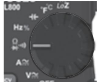
**REMARQUE :** Lorsqu'une fonction de test de résistance est sélectionnée et les fils d'essai ne sont pas en contact (ils ne sont pas connectés de part et d'autre d'une résistance), ou encore, lorsqu'une résistance défectueuse est testée, l'écran affiche « O.L. ». Cela est normal.
