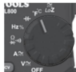
**! Retire el termopar antes de configurar el multímetro en otras funciones de medición.**
