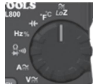
2. Aplique los cables de prueba al circuito que se probará para medir el voltaje. El multímetro seleccionará automáticamente un rango para mostrar la medición en el rango más adecuado.
