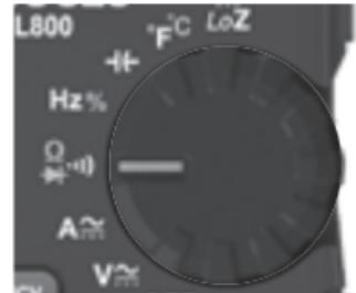
**REMARQUE :** Lorsqu'une fonction de test de résistance est sélectionnée et les fils d'essai ne sont pas en contact (ils ne sont pas connectés de part et d'autre d'une résistance), ou encore, lorsqu'une résistance défectueuse est testée, l'écran affiche « O.L. ». Cela est normal.
